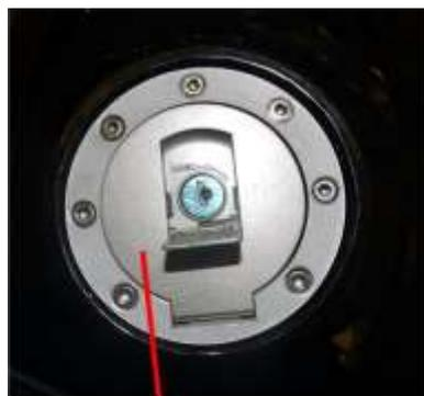
Крышка топливного бака
